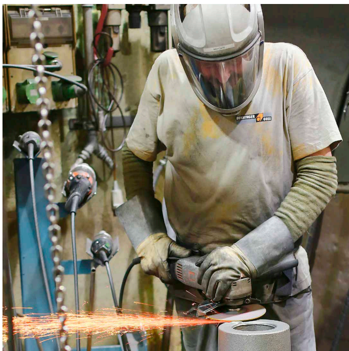
Die Mitarbeiter in der Gussnachbehandlung arbeiten in Schutzkleidungen mit gekühlten Schutzhelmen inklusive Frischluftzufuhr. Damit werden die Augen vor kleinen Metallspänen geschützt.
