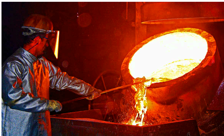
Mit dem «Abschlacken» wird die Schmelze von Verunreinigungen befreit.
